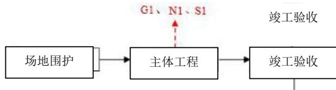
图 2-2 本项目麻石路面施工工艺流程及产排污环节图
